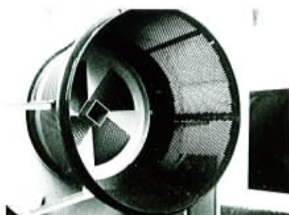
(2) Détail du cône d'égouttage (optionnel)
